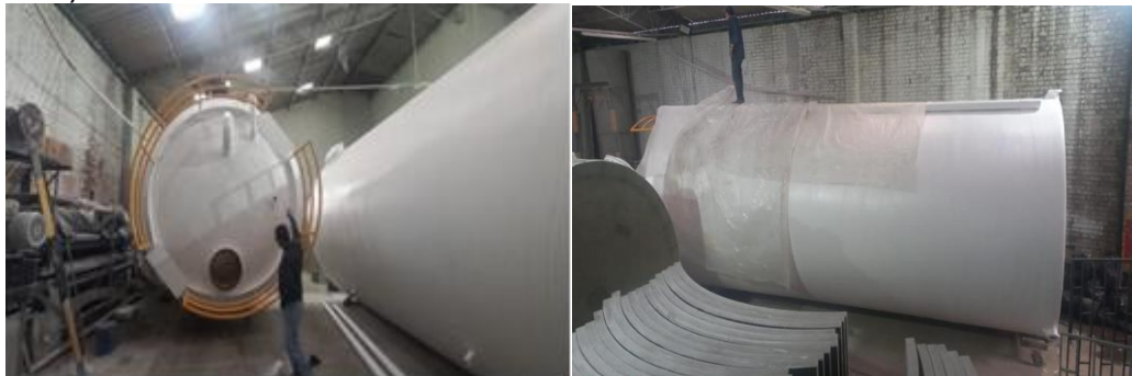
Figura 18. Frente de Obra # 6 – Tanques PFRV Almacenamiento Productos Químicos (En Fabricación).
