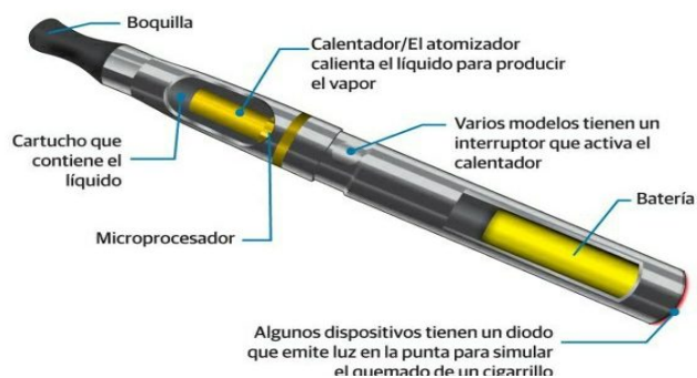
Lamina 4: Partes de un vaporizador o cigarrillo electrónico Partes de un cigarrillo electrónico
