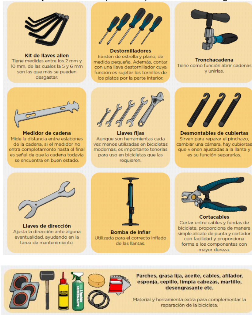
Cuadro 1: Materiales y herramientas para la reparación de una urgencia en bicicletas.
