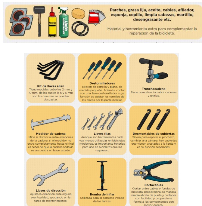
Figura 1: Materiales y herramientas para la reparación de una urgencia en bicicletas.
